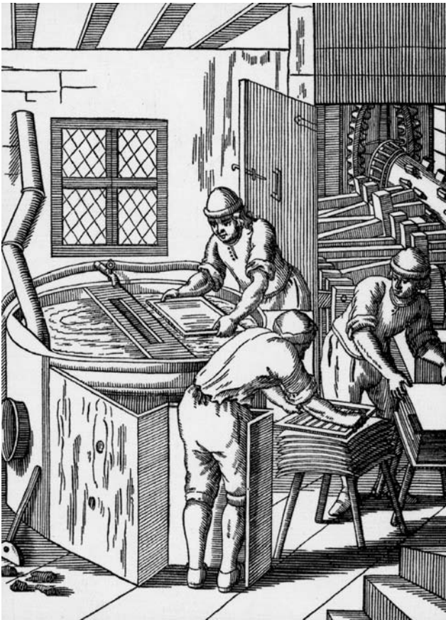
Abb. 3: Papierfertigung mit dem Schöpfsieb, Holzschnitt von 1698.
